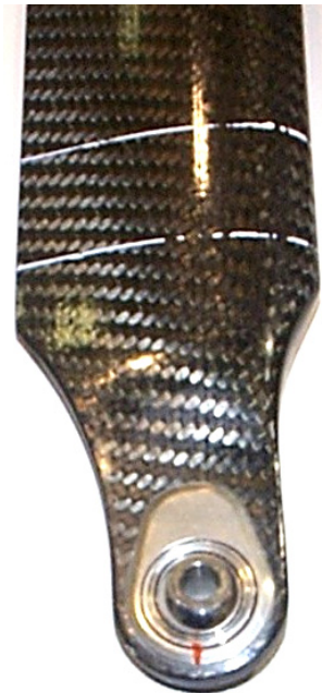
Figure 14. Honda F1 2007 front push rod
